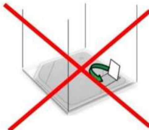
Figure 10-1D : exemple de trappe en VOLUME 0
